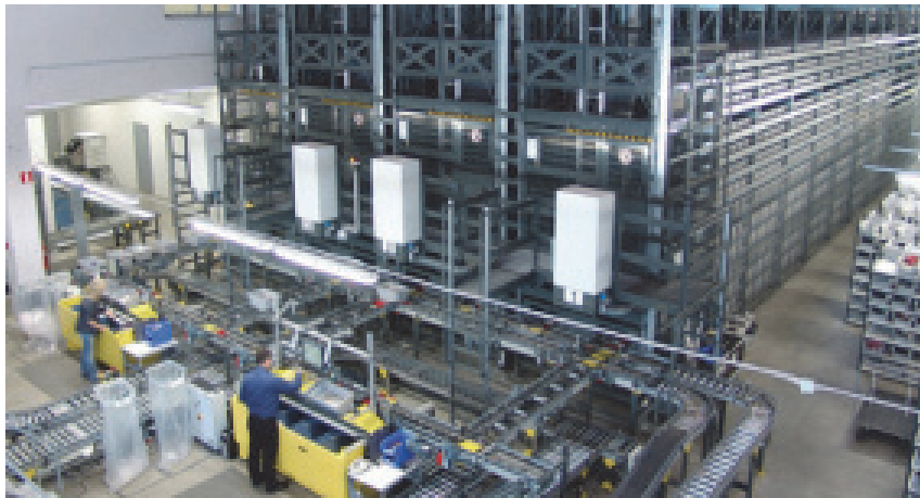
[그림 6] Shuttle type ASRS
